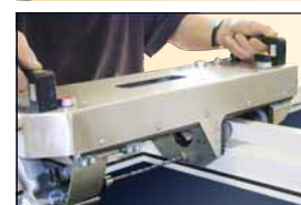
exakte Bohrerführung - pneumatischer Vorschub
